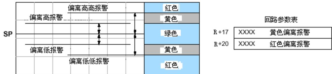
限幅确定了相对于SP值的波动区域。SP值周围的绿区代表安全（无报警）方式，黄区在绿色区域的外面，红区在这两个区的外面。
