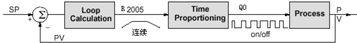
例子中的程序使用两个定时器来进行On/Off控制。要做下列**设定**：
