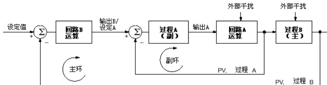
通过检查它对外部干扰的响应，可以看到串级控制有其优越性。记住，副环比主环动作得更快。因此，如果干扰影响了副环中的过程A，那么回路A的PID运算会在主环受到影响之前修改偏差。
