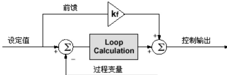
在上一节偏移项的介绍中，我们讲过偏移值建立了一个“工作区”或控制输出的操作点。当偏差越接近零点时，输出就越接近偏移值。当设定值发生变化时，产生了偏差且产生新的输出值。如因干扰产生新的偏置量，也会如此。积分作用必须增加/减少，直到消除偏差。
