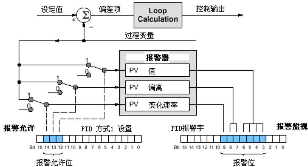
与PID运算不同，当CPU处于运行方式的任何时候，报警都会起作用。回路可能在手动，自动或串级方式，如果上面所列的有效位被置为1则报警就起作用。
