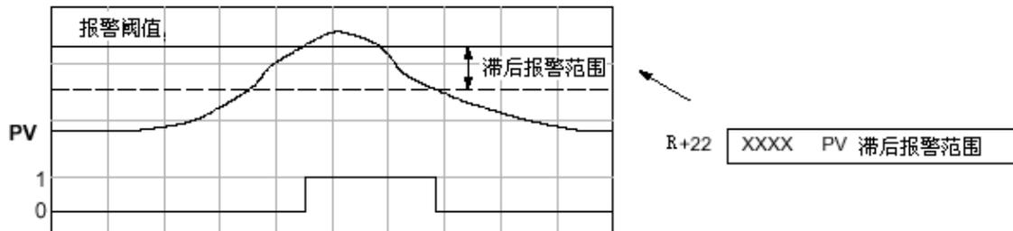
超过限幅值后，使用滞后量让它朝安全区变化。用此方法，报警一超过设置的限幅值就发生作用。它延时关闭，直到PV值已按滞后量回到限幅值。
