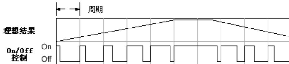
如果我们绘制出热气球中燃烧器的on/off时间，我们可能将会看到对气球温度和高度的类似的影响关系。
