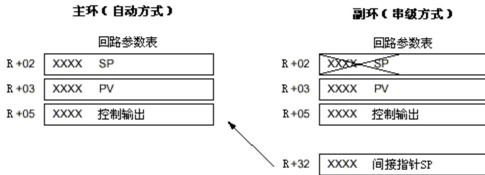
使用DirectSOFT的PID视图来监视副环的SP值时，DirectSOFT自动读出主环的控制输出并把它显示成副环的SP。副环正常的SP地址，R+02，仍然不变。
