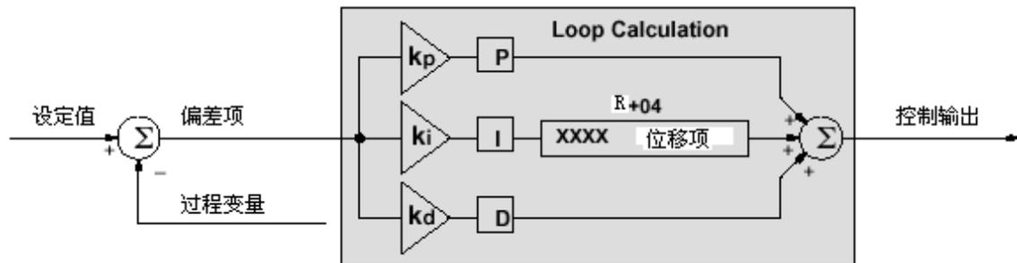
为了改变偏移量，梯形逻辑程序只须把理想值写入R+04。PID运算回路首先从R+04中读出偏移值并根据当前积分运算修正偏差。然后再把结果写到地址R+04。这种方式一目了然，所以前馈控制就是将合适的数值在适当的时候写入偏差项（如下例所示）。
