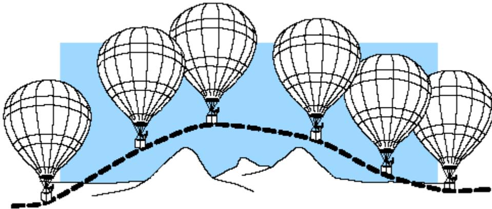
时间-比例控制的负荷与ON时间/OFF时间比率近似于连续控制。下图显示了当负荷被整个过程均分时，它是如何近似于一个连续曲线的例子。
