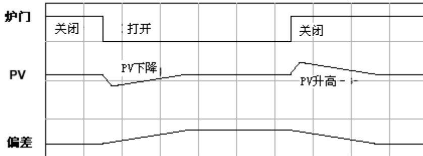
首先，回路控制器记下当门打开或关上时产生的偏差值的变化大小。然后，写入一段梯形逻辑程序来监控炉门的限位开关的位置。当门打开时，梯形图程序就从R+04中读出当前的偏差值，加上理想的变化量，再写回到R+04中。当门关上时，重复这些步骤，但要减去理想的变化量。结果如下图所示。
