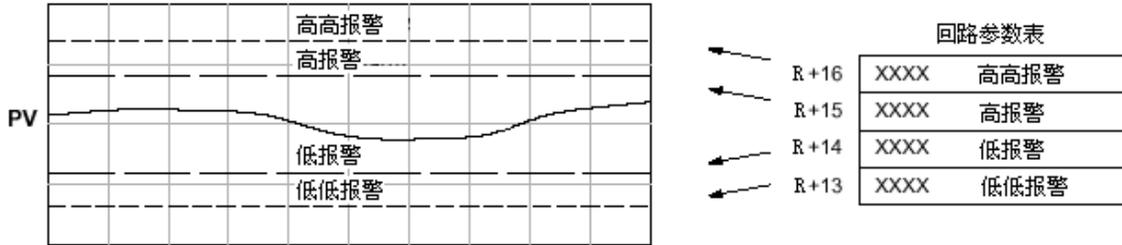
如果在一段时间内过程仍然失控，最后PV将越过外面的报警限幅，即高-高报警和低-低报警。它们的限幅值用上面列出的控制回路参数表寄存器设置。高-高或低-低报警表明情况严重，需要操作员立即注意。
