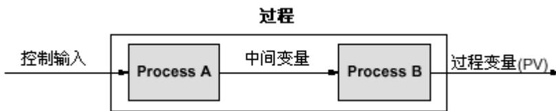
**串级回路的原理很简单，我们只要加上另一个过程回路来更精确地控制中间变量就行了！** 它把控制滞后的对象也分成两部分。
