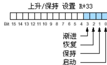
梯形逻辑程序必须把控制位设置成“1”，执行相应的功能。当回路控制器读到上升/保持的值时，它自动切断该位。因此，当CPU处于运行方式时，此位不需要复位。
