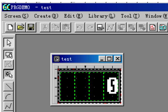
本例中，为了使用触摸面板，要在部品里添加一个开关。通过菜单或通过快捷方式选择“Control” - “Switch”（“控件” - “开关”）。弹出开关控件属性对话框，点击“Arrange”，光标变成小鼠形状。点击部品编辑窗口，光标变成方形开关控件形状，将其放于部品的左上角。然后用鼠标点击本控件，并拖住控件右下角，将其拉至适当大小。注意，因为是开关控件，所以拉大或缩小时只能与 20dots × 20dots 为单位。
