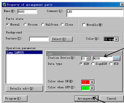
输入所连接 PLC 的功能存储器的名称
