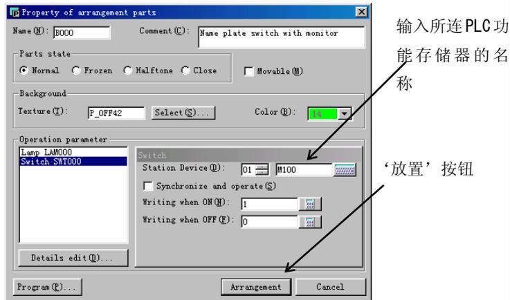
e. 输入与开关相连的 PLC 功能存储器的名称。
