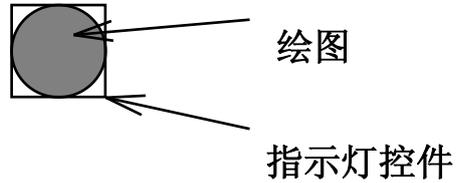
注意: 指示灯由 OFF 变 ON 时, 其颜色也相应地由 “OFF 颜色” 变成 “ON 颜色”。所以给绘图填充颜色时必须用 “OFF 颜色”。
