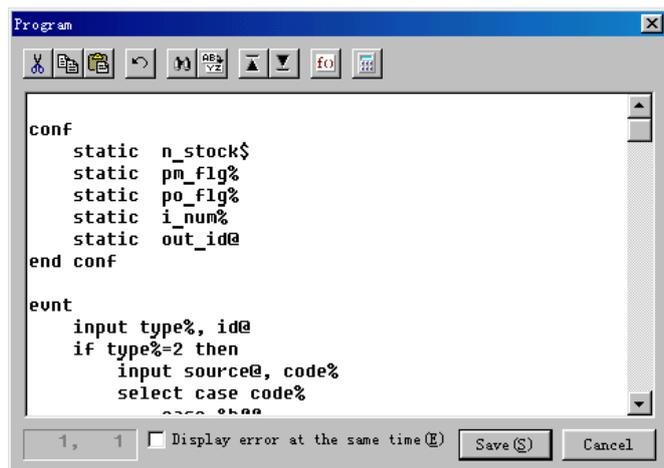
点击部品属性的“Program”按钮激活程序编辑器，可以发现很多标准部品没有程序，这些标准部品只是通过控件获得它们的功能，因此没有必要为那些功能编写程序。
