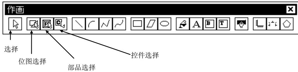
绘画工具条的图标可以用来安排位图，还可以安排屏幕画面和部品。工具条最左边四个图标用来选择在窗口中使用的对象类型。位图（绘画元素）和部品覆盖在屏幕上，这样可能很难选择想要选择的对象，此时可以点击上述图标限制选择的对象类型。
