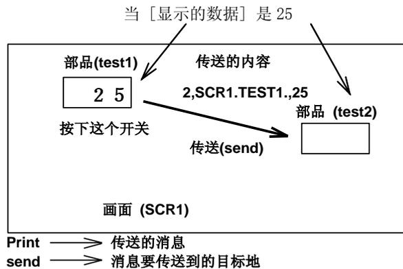
程序到此结束。当开关按下时，程序将包括参数[要显示地数据]、[目标部品名称]在内的消息发送出去。
